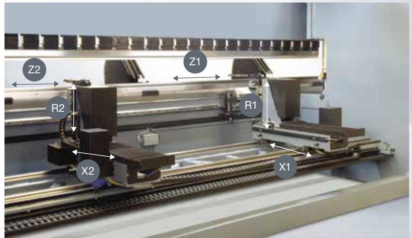
CNC Opsiyonel Arka Dayama X1 - X2, R1 - R2, Z1 - Z2
