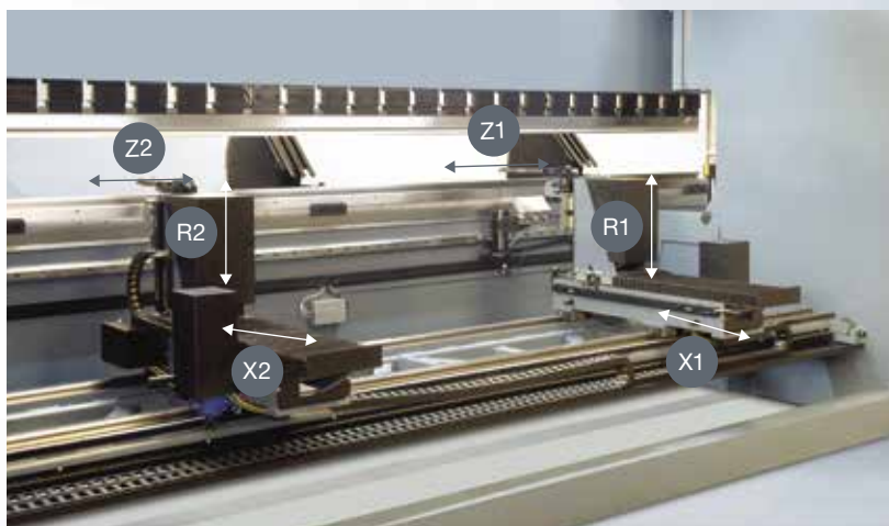
CNC optional back gauge X1 - X2, R1 - R2, Z1 - Z2
